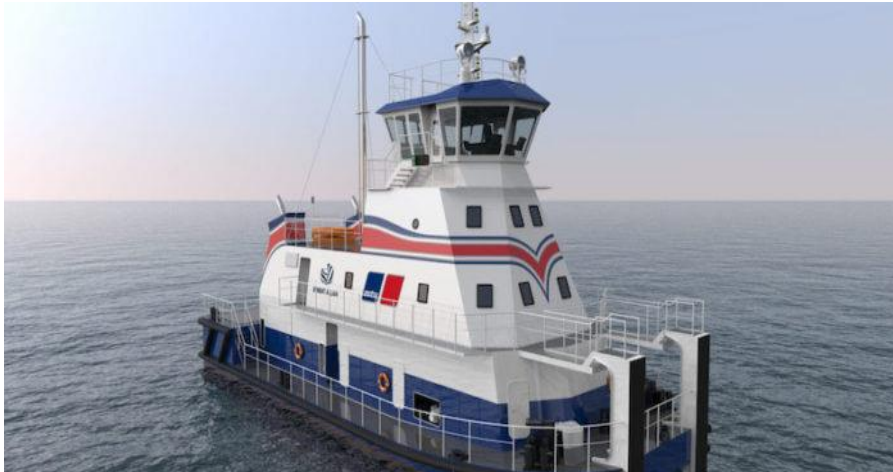
Fig 30. LNG fueled shallow draft pushboat [27]
