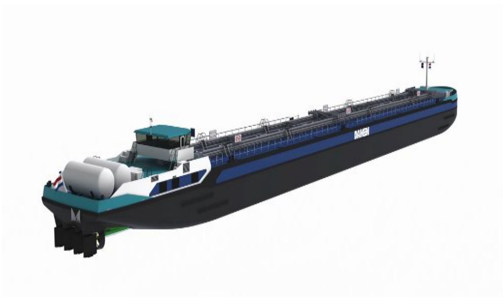
Fig 29. LNG powered inland barge [26]
