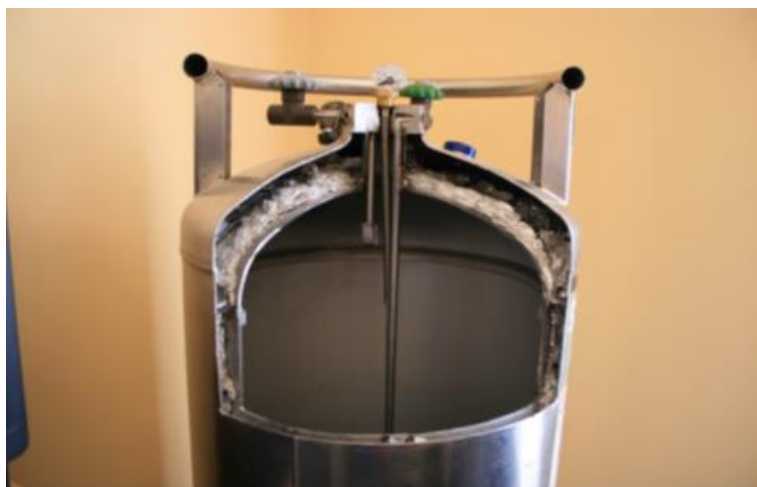
Fig 11. LNG tank cross-section (volume 1,5 \text{m}^3 ) [12]
