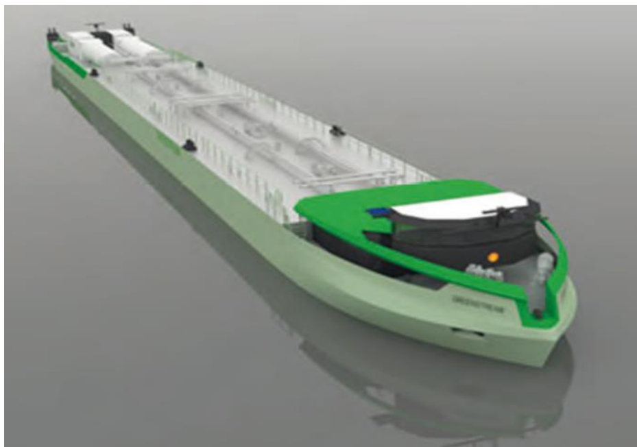
Fig 27. LNG powered tank barge [25]
