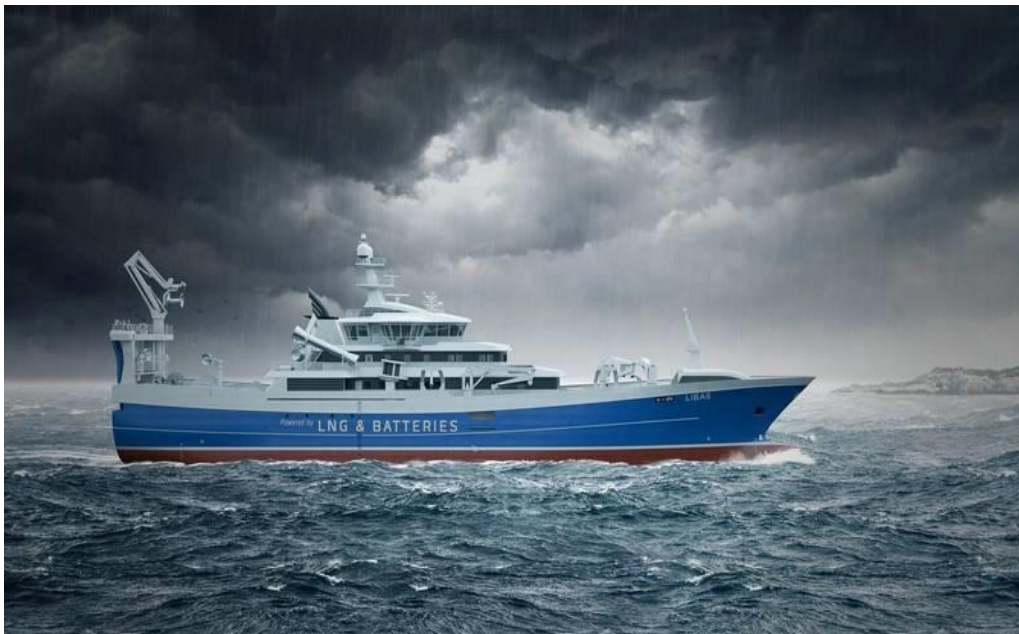
Fig 25. LNG-Fueled Fishing Trawler [23] length – 35 m, LNG tank capacity - 350 m 3
