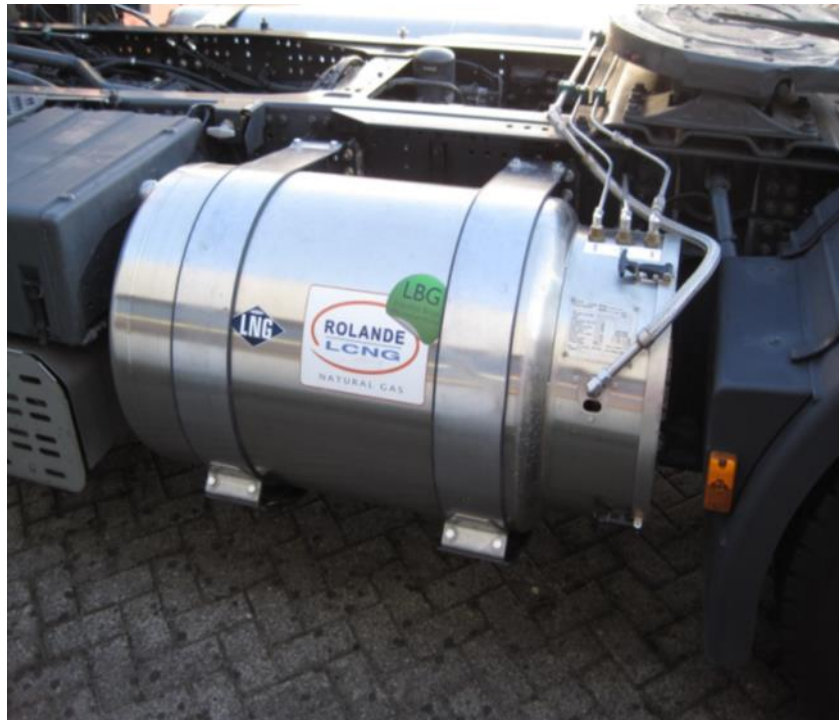
Fig 12. LNG truck fuel block [12]
