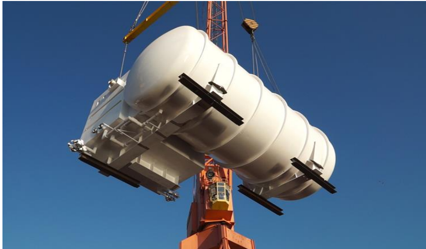
Fig 9. Marine LNG fuel block [11]
