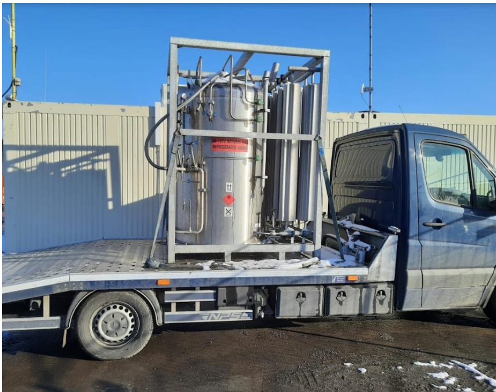
Figure 9. Cryogenic tank (mini-tank) for the transport of bioLNG / LNG - Microfueller LNG
