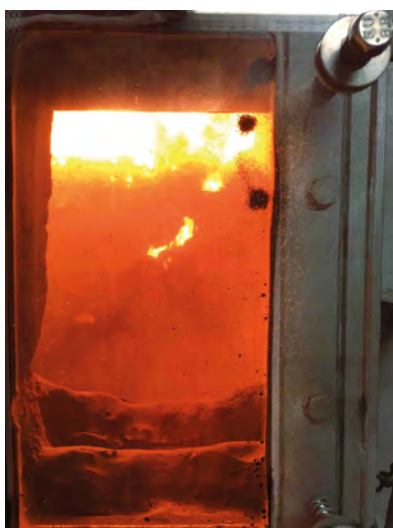
Wnętrze instalacji do spalania odpadów, około 1000°C
