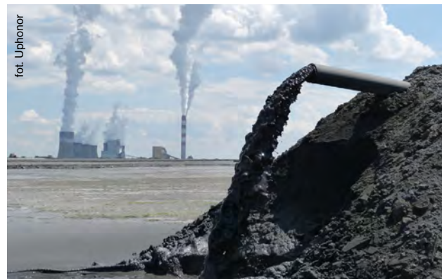
Hydrotransport popiołów rurami WehoSlurry na składowisku Bagno Lubień Elektrowni Bełchatów
