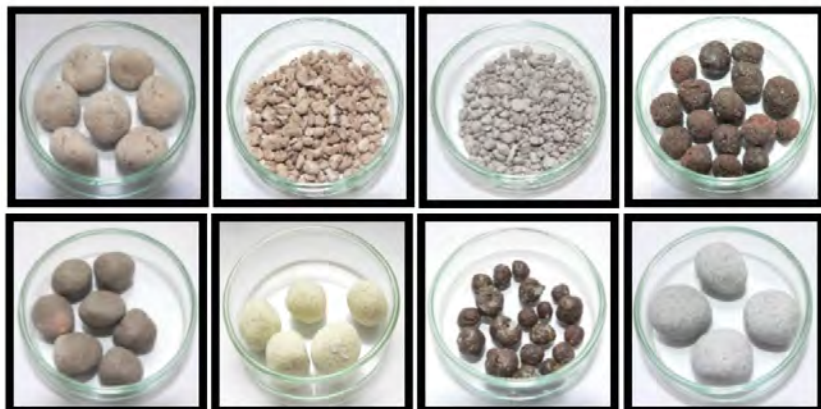
Rys. 3. Przykłady kruszyw z osadów ściekowych
