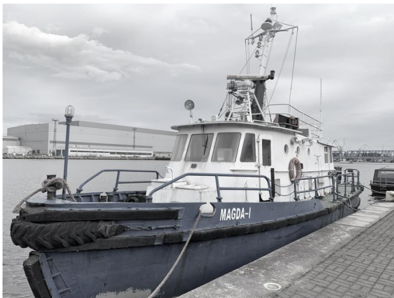
Rysunek 5. Jednostka Magda I (podstawowe dane: długość – 18 m; szerokość – 4,28 m; zanurzenie – 2,83 m; GT – 42,71; NT – 7,51; nośność – 5,5 t) [opracowanie własne]
