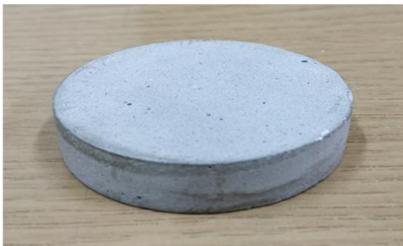
Rysunek 2. Próbką do badań zaczynów cementowych z mikrosferami szklanymi [opracowanie własne]
